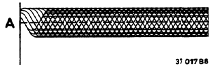
Oszilloskopstellung 0,5 μs/div. Amplitude ca. 1,5 V SS
